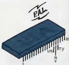
A través de los pines 15, 16 y 17 (U, P e V) se emiten la totalidad de las señales requeridas por el sistema P.A.L.
